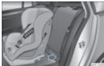
Rys. 26 Siedzenia tylne: montaż fotelika dziecięcego za pomocą systemu ISOFIX.
