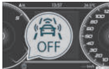
Rys. 159 Na wyświetlaczu tablicy rozdzielczej: Front Assist wyłączony.
