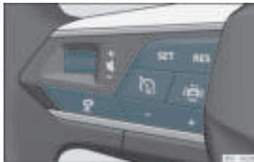
Rys. 161 Na kierownicy wielofunkcyjnej: przyciski do obsługi aktywnego tempomatu
