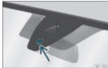
Rys. 130 Czujnik wilgotności i temperatury przedniej szyby
