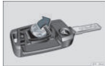
Rys. 73 Kluczyki samochodowe: wyjmowanie baterii.
