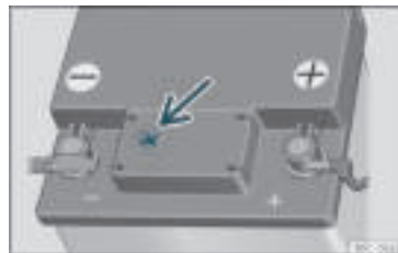
Rys. 208 Wziernik na górze baterii 12 V (schematyczne przedstawienie).
