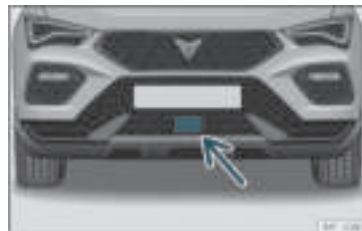
Rys. 148 Na przednim zderzaku: czujniki radarowe.
