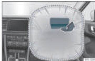
Rys. 14 Czołowa poduszka powietrzna pasażera umieszczona w desce rozdzielczej.
