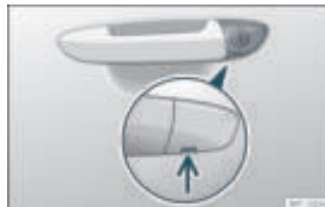
Rys. 78 Klamka drzwi kierowcy: Ukryta wkładka zamka.
