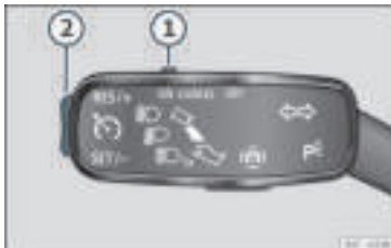
Rys. 155 Na dźwigni kierunkowskazów: przełącznik i przyciski do obsługi tempomatu.
