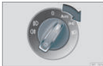
Rys. 92 Tablica rozdzielcza: przełącznik światel.
