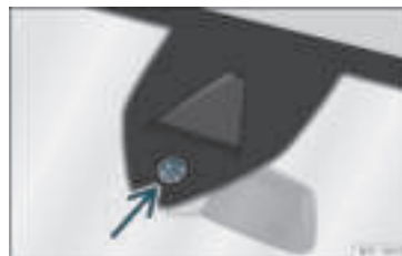
Rys. 98 Powierzchnia aktywna czujnika deszczu
