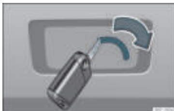
Rys. 87 Szczegół bagażnika: awaryjne odryglowanie
