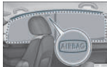
Rys. 20 Umiejscowienie poduszek powietrznych chroniących głowę.
