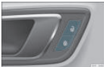
Rys. 70 Drzwi kierowcy: przycisk centralnego zamka.
