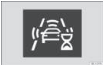
Rys. 183 Na wyświetlaczu tablicy rozdzielczej: wstępna samokalibracja systemu.
