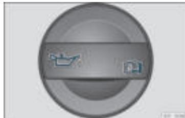
Rys. 228 W komorze silnika: Korek wlewu oleju silnikowego.
