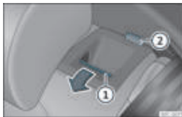
Rys. 101 Tylnie siedzenie: składanie oparcia.
