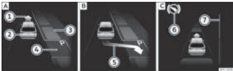
Rys. 205 Na wyświetlaczu tablicy rozdzielczej: parkowanie równoległe. [A] Znalezienie miejsca parkingowego. [B] Położenie parkowania. [C] Wykonywanie manewrów.
