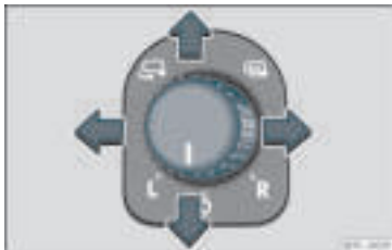
Rys. 94 Szczegółowy widok drzwi kierowcy: regulacja lusterka bocznego.
