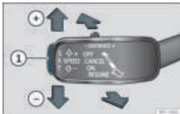
Rys. 179 Po lewej stronie kolumny kierownicy: przyciski do obsługi ogranicznika prędkości.
