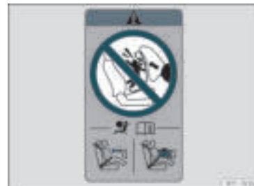
Rys. 23 Naklejka z symbolem poduszki powietrznej: w tylnej części ramy drzwi po stronie pasażera
