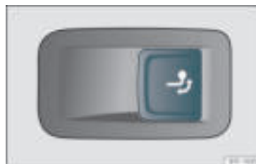
Rys. 220 Z prawej strony bagażnika: przycisk do odblokowania zaczepy.
