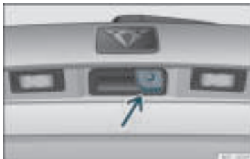
Rys. 217 Uchwyt pokryw bagażnika: umiejscowienie kamery cofania.
