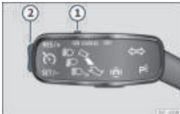
Rys. 176 Na dźwigni kierunkowskazów: przełącznik i przyciski do obsługi tempomatu.
