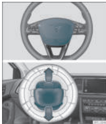
Rys. 12 Poduszka powietrzna kierowcy umieszczona w kierownicy.
