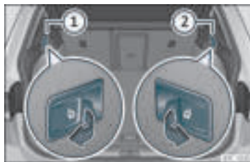
Rys. 102 W bagażniku: dźwignie do wypięcia lewej części ① i prawej części ② oparcia tylnego siedzenia.
