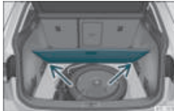
Rys. 109 Regulowana podłoga bagażnika: pozycja nachylona.
