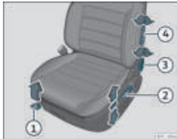
Rys. 96 Fotele przednie: regulacja ręczna.
