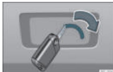
Rys. 82 Szczegóły bagażnika: awaryjne odryglowanie
