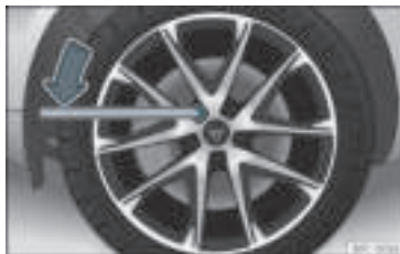
Rys. 32 Zmiana koła: poluzować śruby koła.
