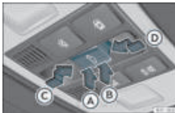
Rys. 84 W podsuficie: przycisk sterowania otwieraniem dachu.
