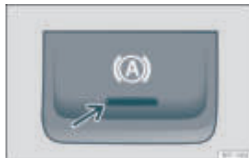
Rys. 201 W dolnej części konsoli środkowej: przycisk funkcyjny Auto Hold.
