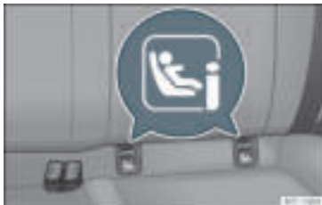
Rys. 24 Tylne siedzenie: Uchwyty mocujące ISO-FIX/iSize.
