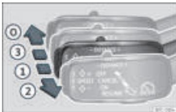
Rys. 187 Po lewej stronie kolumny kierownicy: trzecia dźwignia do obsługi aktywnego tempomatu.
