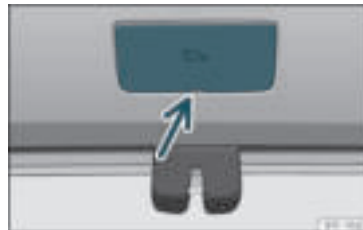
Rys. 81 Szczegóły bagażnika: dostęp do odryglowania awaryjnego.
