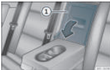
Rys. 114 W oparciu tylnego siedzenia: otwieranie przejścia do bagażnika.
