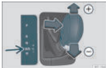
Rys. 171 Konsola środkowa: tiptronic (automatyczna skrzynia biegów)
