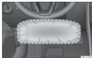
Rys. 17 Po stronie kierowcy: promień działania poduszki chroniącej kolana.
