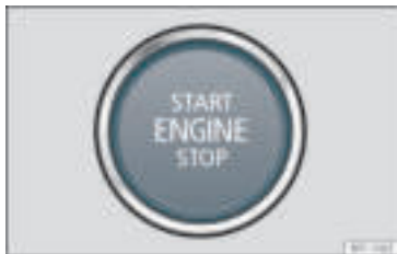
Rys. 167 W dolnej części konsoli środkowej: przycisk rozrusznika.
