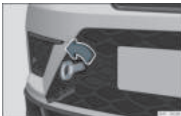
Rys. 40 Z prawej strony zderzaka przedniego: pierścień holowniczy na miejscu.
