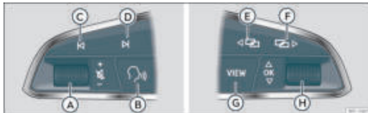
Rys. 65 Przyciski sterujące umieszczone na kole kierownicy.
