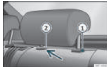
Rys. 100 Zagłówek z tyłu: zdejmowanie.
