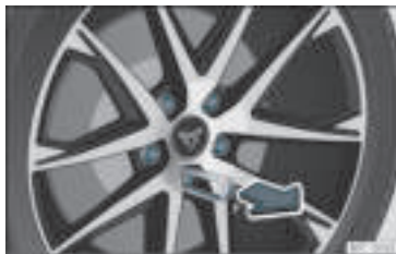
Rys. 30 Koło: śruby kół z nasadkami.
