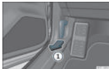
Rys. 224 Pociągnąć za dźwignię pod deską rozdzielczą.
