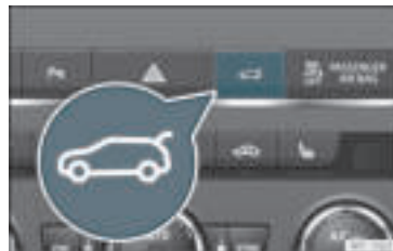
Rys. 79 Konsola środkowa: przycisk otwierania i zamykania klapy bagażnika.
