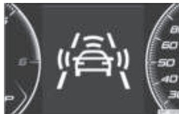
Rys. 180 Na wyświetlaczu tablicy rozdzielczej: wczesne ostrzeżenia.
