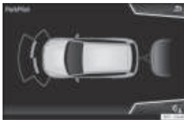
Rys. 212 Obraz z systemu wspomaganie parkowania, z dołączoną przyczepą.
