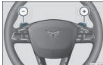
Rys. 172 Kierownica: dźwignie automatycznej skrzyni biegów
