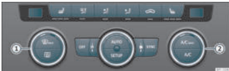
Rys. 122 W konsoli środkowej: przełączniki do sterowania klimatyzacją Climatronic.
