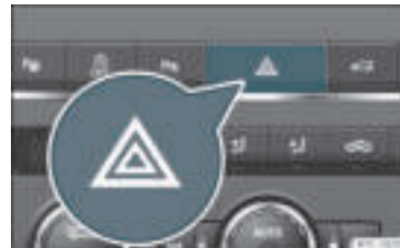
Rys. 90 Deska rozdzielcza: przełącznik świateł awaryjnych
