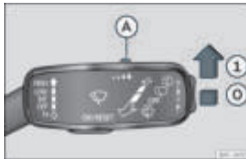
Rys. 92 Dźwignia przełącznika wycieraczek: regulacja czujnika deszczu (A)
