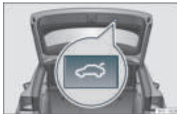
Rys. 78 Pokrywa bagażnika: przycisk do zamykania pokrywy bagażnika.
