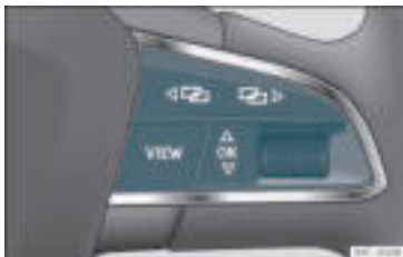
Rys. 61 Prawa strona kierownicy wielofunkcyjnej: przyciski do menu i wskazań informacyjnych na tablicy przyrządów.
