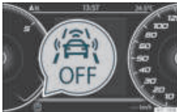
Rys. 182 Na wyświetlaczu tablicy rozdzielczej: Front Assist wyłączony.
