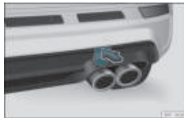
Rys. 41 Po prawej stronie tylnego zderzaka: zdjąć osłonę.
