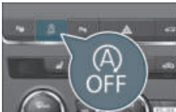
Rys. 169 Konsola środkowa: Przycisk systemu Start-Stop.
