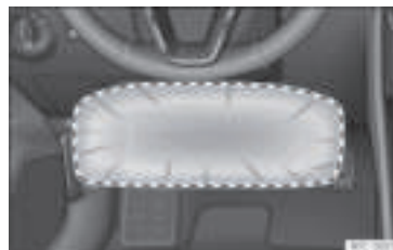
Rys. 17 Po stronie kierowcy: promień działania poduszki chroniącej kolaną.
