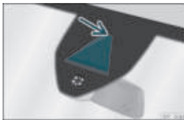
Rys. 192 Na przedniej szybie: pole widzenia Asystenta pasa ruchu.
