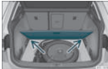
Rys. 109 Regulowana podłoga bagażnika: pozycja nachylona.
