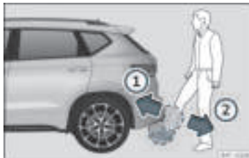
Rys. 80 Pokrywa bagażnika z otwieraniem sterowanym za pomocą czujnika (Easy Open).
