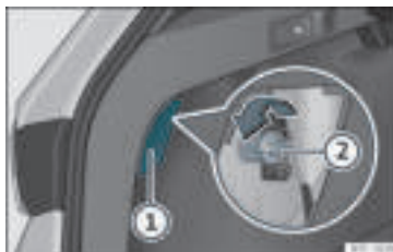
Rys. 47 Bagażnik: dostęp do śruby zabezpieczającej moduł światła tylnych.
