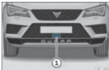
Rys. 181 Na przednim zderzaku: czujniki radarowe.
