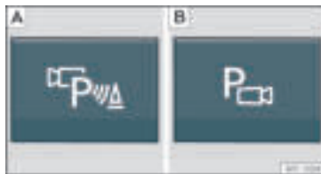
Rys. 215 Konsola środkowa: przycisk ręcznego włączania/wyłączania systemu podglądu otoczenia w połączeniu z systemem wspomagania parkowania ([A]) lub też z systemem tylnych czujników ParkPilot ([B]).
