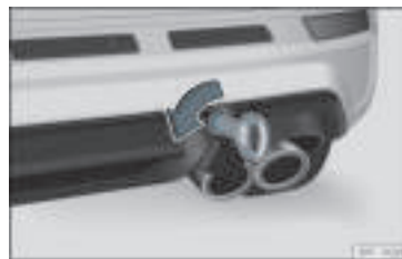
Rys. 42 Po prawej stronie tylnego zderzaka: pierścień holowniczy na miejscu.
