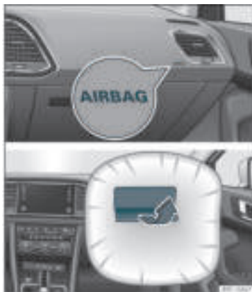
Rys. 13 Czołowa poduszka powietrzna pasażera umieszczona w desce rozdzielczej.
