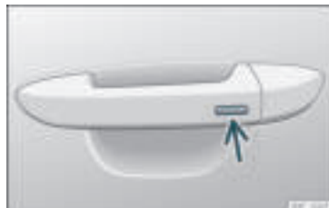
Rys. 86 Klamka drzwi: powierzchnia czujnika.
