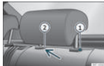
Rys. 100 Zagłówek z tyłu: zdejmowanie.
