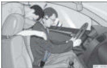
Rys. 7 Pasażer na tylnym siedzeniu nie posiadający zapiętych pasów bezpieczeństwa zostaje gwałtownie wyrzucony do przodu, uderzając kierowcę, który ma zapięty pas.
