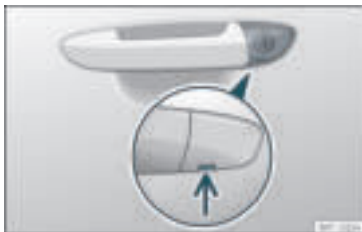
Rys. 73 Klamka drzwi kierowcy: Ukryta wkładka zamka.
