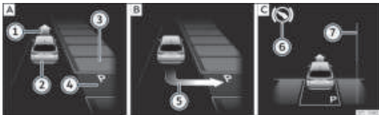
Rys. 206 Na wyświetlaczu tablicy rozdzielczej: parkowanie prostopadłe. [A] Znalezione miejsca parkingowe. [B] Położenie parkowania. [C] Wykonywanie manewrów.
