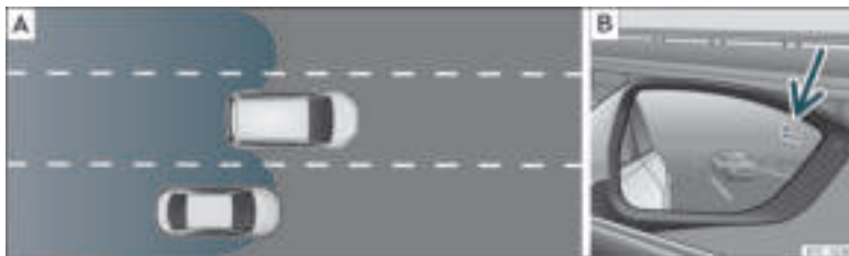
Rys. 198 Schematyczne przedstawienie: [A] Wyprzedzanie połączone ze zjazdem na prawy pas. [B] Sygnalizacja systemu BSD w prawym lusterku bocznym.
