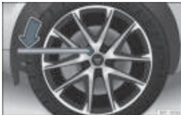
Rys. 32 Zmiana koła: poluzować śruby koła.
