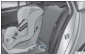
Rys. 25 Siedzenia tylne: montaż fotelika dziecięcego za pomocą systemu ISOFIX.
