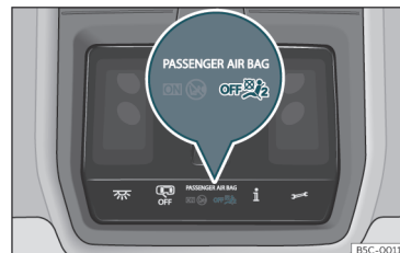
Rys. 16 Na konsoli w podsufitce: lampka kontrolna wyłączenia przedniej poduszki powietrznej pasażera.
