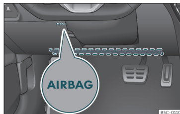
Rys. 17 Po stronie kierowcy: umieszczenie kolanowej poduszki powietrznej
