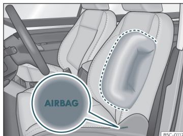
Rys. 21 Boczna poduszka powietrzna w fotelu kierowcy.
