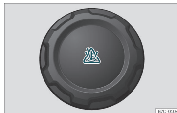
Rys. 189 Komora silnika: korek zbiornika wyrównawczego płynu chłodzącego.
