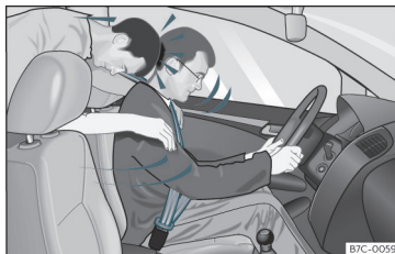
Rys. 8 Pasażer na tylnym siedzeniu nie posiadający zapiętych pasów bezpieczeństwa zostaje gwałtownie wyrzucony do przodu, uderzając kierowcę, który ma zapięty pas.
