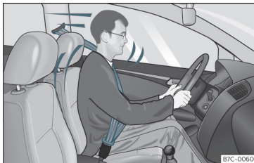
Rys. 6 Prawidłowo zapięty w pas kierowca nie zostanie wyrzucony do przodu w razie nagłego hamowania.
