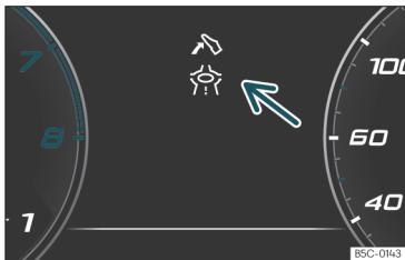
Rys. 54 Kontrolka asystenta jazdy ekonomicznej (przedstawienie schematyczne).
