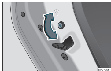
Rys. 76 Blokada drzwi przed dziećmi w drzwiach lewych.
