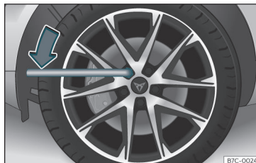
Rys. 37 Zmiana koła: poluzować śruby koła.
