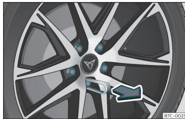
Rys. 35 Koło: śruby kół z nasadkami.
