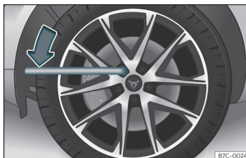
Rys. 37 Zmiana koła: poluzować śruby koła.
