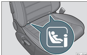
Rys. 28 Przednie siedzenie pasażera: uchwyty mocujące ISOFIX / i-Size.
