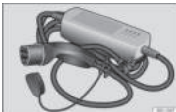
Rys. 207 Przewód łado do gniazd zasilania
