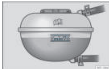
Rys. 217 W komorze silnika: oznaczenia na zbiorniku wyrównawczym płynu chłodzącego.
