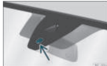
Rys. 101 Powierzchnia aktywna czujnika deszczu »
