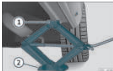
Rys. 43 Belka poprzeczna: podstawianie podnośnika pod pojazdem.
