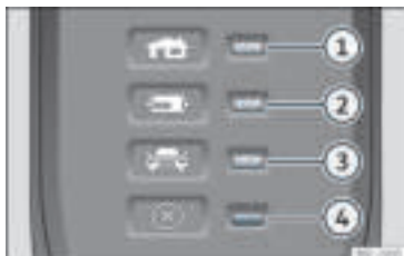
Rys. 208 Na przewodzie ładowania do gniazd zasilania: Lampka kontrolna na urządzeniu ochronnym.
