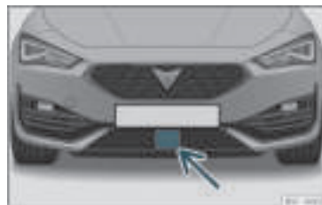
Rys. 159 Na przednim zderzaku: czujniki radarowe.
