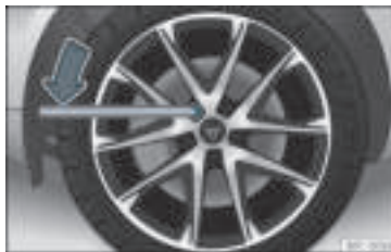
Rys. 41 Zmiana koła: poluzować śruby koła.
