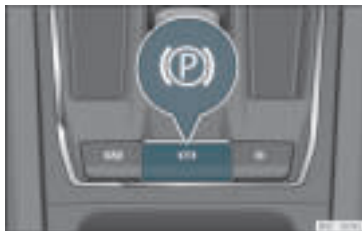
Rys. 186 W dolnej części konsoli środkowej: elektryczny hamulec postojowy
