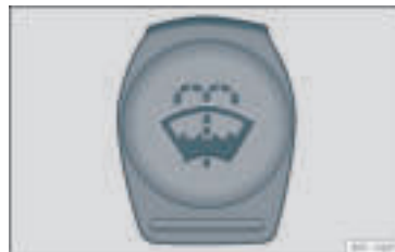
Rys. 220 W komorze silnika: korek zbiornika płynu do spryskiwaczy.
