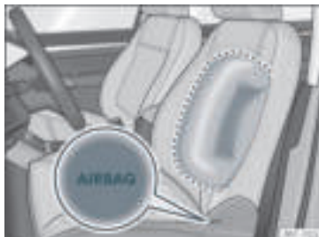
Rys. 25 Boczna poduszka powietrzna w siedzeniu kierowcy.
