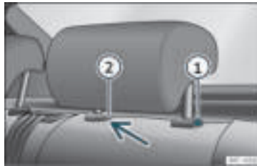
Rys. 108 Zagłówek z tyłu: zdejmowanie.
