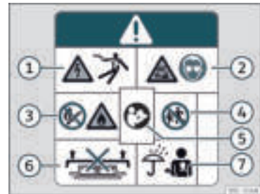
Rys. 201 Napis ostrzegawczy akumulatora wysokonapięciowego.
