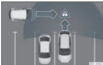
Rys. 183 Diagram przedstawiający działanie systemu monitorowania ruchu poprzecznego przy cofaniu: obszar monitorowany wokół pojazdu wyjeżdżającego z miejsca parkowania.
