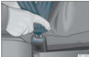
Rys. 13 Wsunąć klamrę pasa bezpieczeństwa do zatrzasku.
