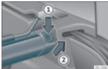
Rys. 132 W bagażniku: zdejmowanie siatki dzielącej.
