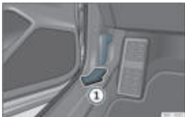
Rys. 212 Pociągnąć za dźwignię pod deską rozdzielczą.
