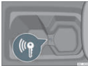
Rys. 154 W konsoli środkowej: rozruch awaryjny.
