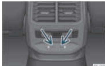
Rys. 152 Z tyłu konsoli środkowej: gniazda USB z funkcją gniazda zasilania.
