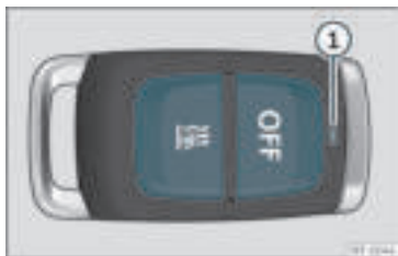
Rys. 144 Ogrzewanie pomocnicze: pilot radiowy zdalnego sterowania.
