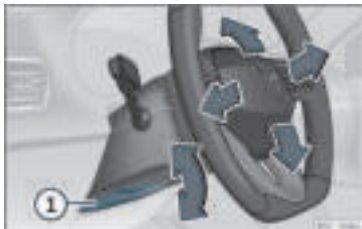
Rys. 8 Dźwignia do dołu, po lewej stronie kolumny kierownicy.
