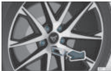
Rys. 35 Koło: śruby kół z nasadkami.
