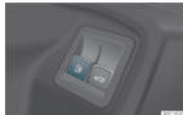
Rys. 198 Drzwi kierowcy: zwalnianie klapy zbiornika.
