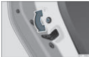
Rys. 80 Blokady drzwi przed dziećmi w drzwiach lewych.
