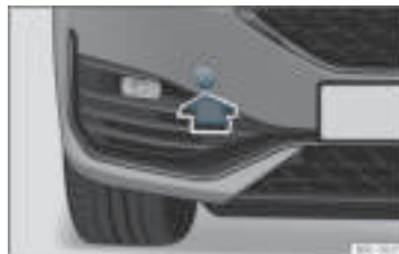
Rys. 43 Z prawej strony zderzaka przedniego: zdjęcie osłone.
