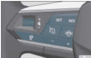
Rys. 159 Na kierownicy wielofunkcyjnej: przyciski do obsługi aktywnego tempomatu
