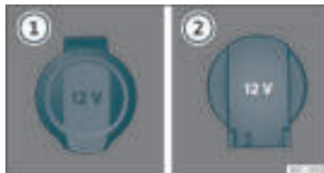
Rys. 129 Gniazdo zasilania 12 V: ① w przednim podłokietniku, ② w bagażniku.
