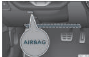
Rys. 17 Po stronie kierowcy: umieszczenie kolanowej poduszki powietrznej
