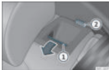
Rys. 106 Tyłne siedzenie: składanie oparcia.
