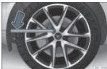
Rys. 37 Zmiana koła: poluzować śruby koła.
