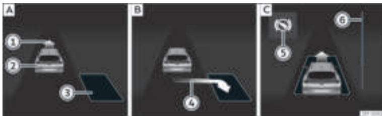
Rys. 180 Na wyświetlaczu tablicy przyrządów: parkowanie równoległe. [A] Znalezione miejsce parkingowe. [B] Miejsce do zaparkowania. [C] Manewrowanie.
