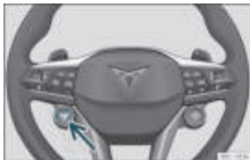
Rys. 147 Kierownica wielofunkcyjna*: przycisk do zmiany profilu jazdy.
