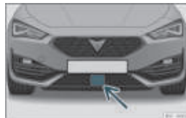
Rys. 148 Na przednim zderzaku: czujniki radarowe.
