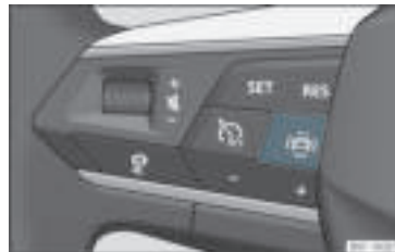
Rys. 62 Lewa strona kierownicy wielofunkcyjnej: przycisk systemów wspomagania kierowcy (w zależności od wersji).
