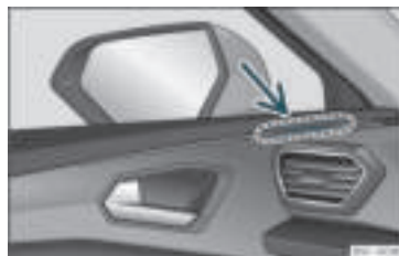
Rys. 168 Lampka kontrolna pojazdu systemu ostrzegania o zjeżdżaniu z pasa ruchu.
