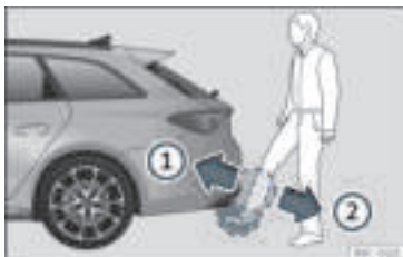
Rys. 84 Kłapa bagażnika z otwieraniem sterowanym za pomocą czujnika (Easy Open).
