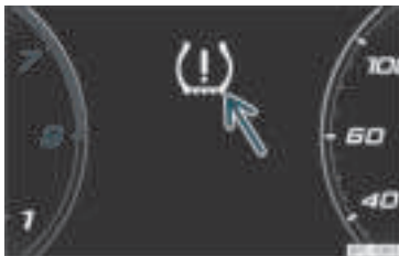
Rys. 215 Tablica przyrządów: ostrzeżenie o spadku ciśnienia w oponach.
