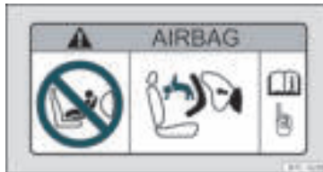
Rys. 25 Naklejka z symbolem poduszki powietrznej: na osłonie przeciwsłonecznej pasażera
