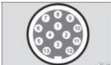
Rys. 186 Schemat: opis styków w gnieździe elektrycznym przyczepy.
