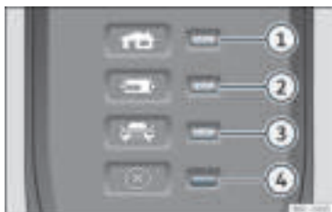
Rys. 197 Na przewodzie ładowania do gniazd zasilania: Lampka kontrolna na urządzeniu ochronnym.
