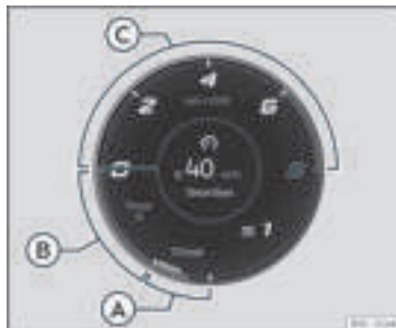
Rys. 56 Cyfrowa tablica przyrządów: Wskaźnik mocy (widok klasyczny)
