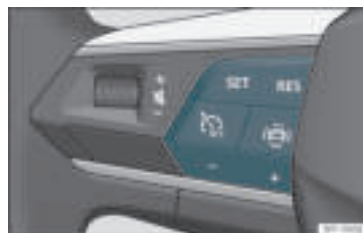
Rys. 154 Na kierownicy wielofunkcyjnej: przyciski do obsługi ogranicznika prędkości.
