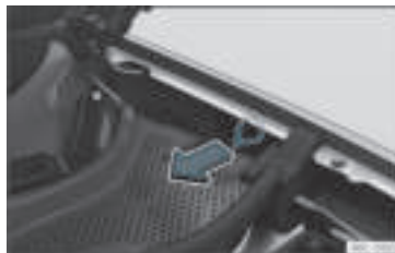
Rys. 194 Pomiędzy panelem lewego skrzydła a zawiasem maski silnika: Ściągacz ręcznego mechanizmu zwalnającego złącze ładowania.
