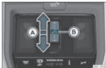
Rys. 87 W podsufrze: przycisk sterowania otwieraniem dachu.
