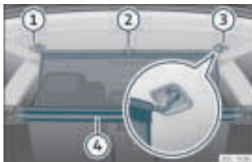
Rys. 121 W bagażniku: mocowanie siatki dzielącej.
