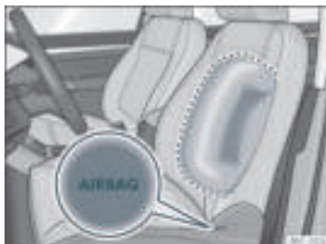
Rys. 21 Boczna poduszka powietrzna w siedzeniu kierowcy.
