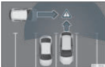
Rys. 172 Diagram przedstawiający działanie systemu monitorowania ruchu poprzecznego przy cofaniu: obszar monitorowany wokół pojazdu wyjeżdżającego z miejsca parkowania.
