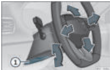
Rys. 4 Dźwignia do dołu, po lewej stronie kolumny kierownicy.
