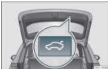
Rys. 82 Kłapa bagażnika: przycisk do zamykania klapy bagażnika.
