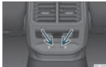
Rys. 141 Z tyłu konsoli środkowej: gniazda USB z funkcją gniazda zasilania.
