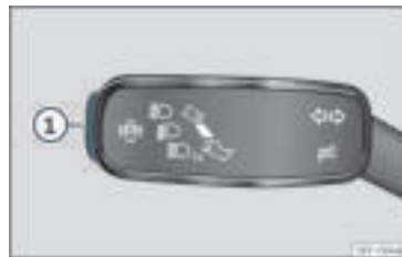
Rys. 61 Na dźwigni kierunkowskazów i świateł drogowych: przycisk systemów wspomagania kierowcy (w zależności od wersji).
