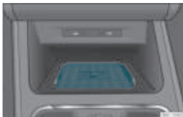
Rys. 139 W konsoli środkowej: miejsce do podłączenia telefonu komórkowego.
