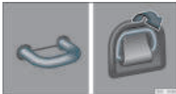
Rys. 115 W bagażniku: stałe i rozkładane uchwyty mocujące.
