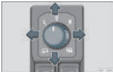
Rys. 97 Szczegółowy widok drzwi kierowcy: regulacja lusterka bocznego.
