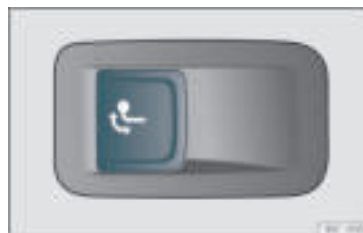
Rys. 187 Po lewej stronie bagażnika: przycisk do odblokowania zaczepy.
