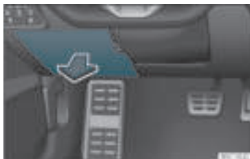
Rys. 47 Deska rozdzielcza po stronie kierowcy: pokrywa skrzynki bezpieczników.
