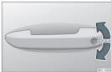
Rys. 78 Klamka drzwi kierowcy: cylinder zamka.
