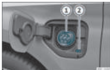
Rys. 191 Za pokrywą ładowania akumulatora, z przodu po lewej stronie: Gniazdo ładowania
