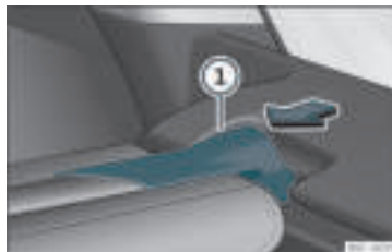
Rys. 110 W bagażniku: wyjmowanie rolety.
