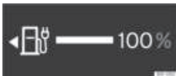
Rys. 58 Cyfrowa tablica przyrządów: wskaźnik poziomu baterii.
