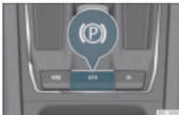
Rys. 175 W dolnej części konsoli środkowej: elektryczny hamulec postojowy
