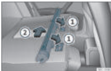
Rys. 123 Mocowanie siatki dzielącej do oparcia siedzenia tylnego.
