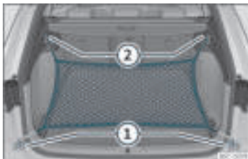
Rys. 117 W bagażniku: uchwyty ① i haczyki ② do mocowania torby siatkowej.
