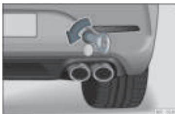
Rys. 46 Po prawej stronie tylnego zderzaka: pierścień holowniczy na miejscu.
