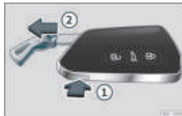
Rys. 71 Kluczyki samochodowe: wyjmowanie trzpienia kluczyka
