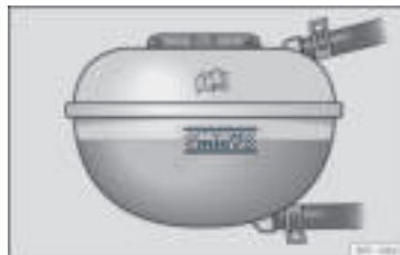
Rys. 206 W komorze silnika: oznaczenia na zbiorniku wyrównawczym płynu chłodzącego.
