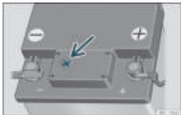
Rys. 210 Wziernik na górze baterii 12 V (schematyczne przedstawienie).
