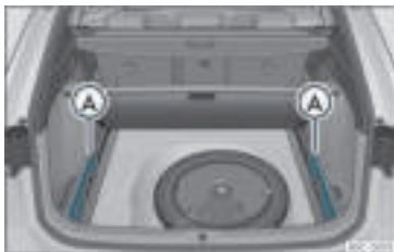
Rys. 111 W bagażniku: miejsce do schowania rolety.
