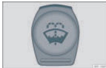
Rys. 209 W komorze silnika: korek zbiornika płynu do spryskiwaczy.
