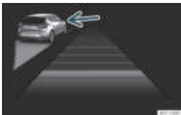
Rys. 161 Na wyświetlaczu tablicy przyrządów: włączony ACC, wykryto pojazd na lewym pasie
