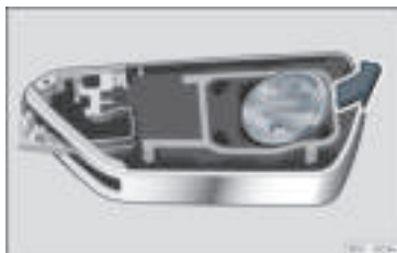
Rys. 73 Kluczyki samochodowe: wymiowanie baterii.
