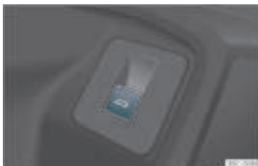
Rys. 83 Na drzwiach kierowcy: przycisk otwierania i zamykania klapy bagażnika.
