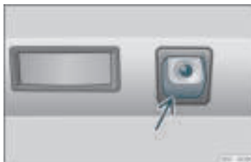
Rys. 153 W tylnym zderzaku: umiejscowienie kamery cofania.
