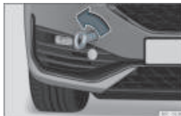
Rys. 44 Prawa strona przedniego zderzaka: pierścień holowniczy na miejscu.
