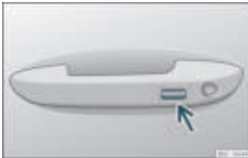
Rys. 88 Klamka drzwi: powierzchnia czujnika.
