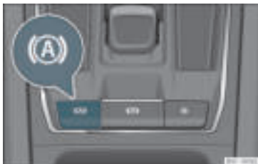
Rys. 176 W dolnej części konsoli środkowej: przycisk funkcyjny Auto Hold.
