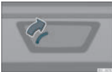
Rys. 85 Szczegół bagażnika: awaryjne odryglowanie
