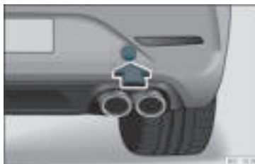
Rys. 45 Po prawej stronie tylnego zderzaka: zdjąć osłonę.
