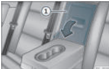
Rys. 119 W oparciu tylnego siedzenia: otwieranie przejścia do bagażnika.
