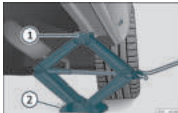
Rys. 39 Belka poprzeczna: podstawianie podnośnika pod pojazdem.
