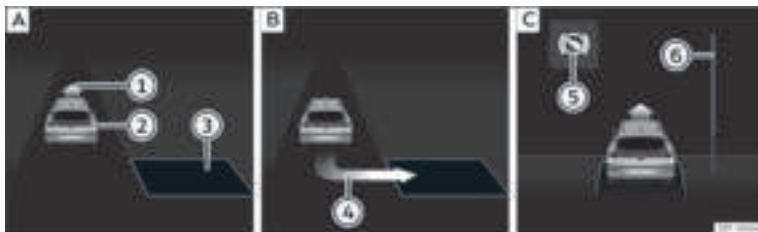
Rys. 181 Na wyświetlaczu tablicy przyrządów: parkowanie prostopadłe. [A] Znalezione miejsce parkingowe. [B] Miejsce do zaparkowania. [C] Manewrowanie.
