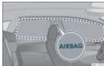
Rys. 23 Umiejscowienie poduszek powietrznych chroniących głowę.
