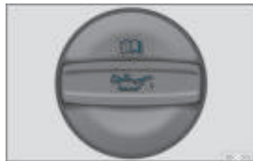
Rys. 205 W komorze silnika: Korek wlewu oleju silnikowego.
