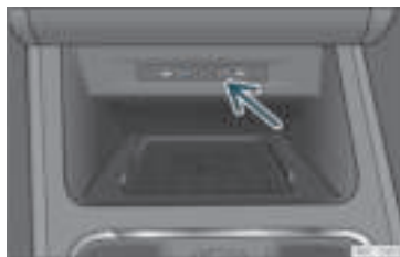
Rys. 151 Konsola środkowa: gniazdo USB.
