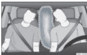
Rys. 24 Całkowicie napęczniona środkowa poduszka powietrzna (strefa zadziałania).
