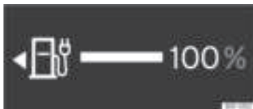
Rys. 62 Cyfrowa tablica przyrządów: wskaźnik poziomu baterii.
