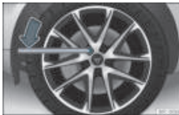
Rys. 41 Zmiana koła: poluzować śruby koła.
