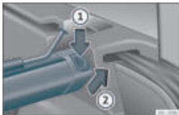
Rys. 132 W bagażniku: zdejmowanie siatki dzielącej.
