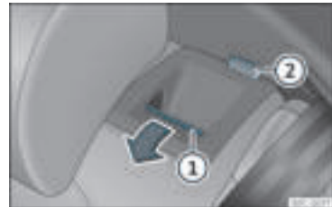
Rys. 111 Tyłne siedzenie: składanie oparcia.
