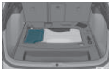
Rys. 222 Umieszczenie akumulatora w bagażniku.
