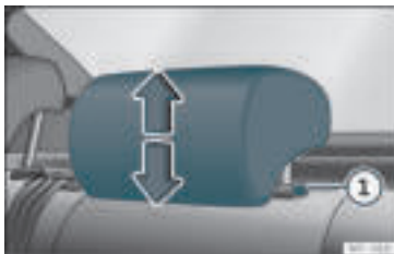
Rys. 107 Zagłówek z tyłu: regulacja zagłówka.
