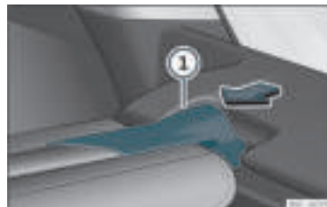
Rys. 119 W bagażniku: wyjmowanie rolety.
