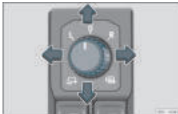
Rys. 102 Szczegółowy widok drzewi kierowcy: regulacja lusterka bocznego.
