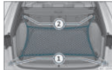
Rys. 126 W bagażniku: uchwyty 1 i haczyki 2 do mocowania torby siatkowej.
