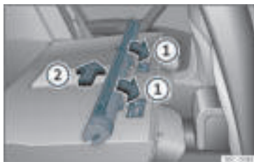
Rys. 133 Mocowanie siatki dzielącej do oparcia siedzenia tylnego.
