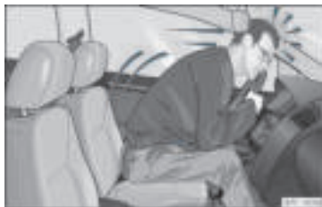
Rys. 11 Kierowca nieposiadający zapiętych pasów bezpieczeństwa zostaje wyrzucony gwałtownie do przodu.
