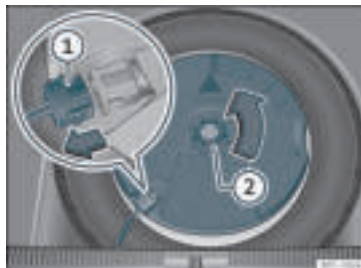
Rys. 228 W bagażniku: wyjąć głośnik niskotonowy.
