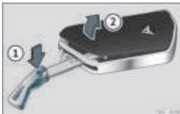
Rys. 76 Kluczyki samochodowe: otwieranie pokrywy baterii.
