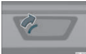
Rys. 90 Szczegół bagażnika: mechanizm ręcznego zwalniania (Leon Sportstourer).
