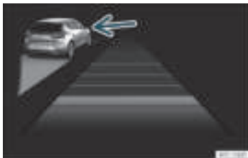
Rys. 172 Na wyświetlaczu tablicy przyrządów: włączony ACC, wykryto pojazd na lewym pasie
