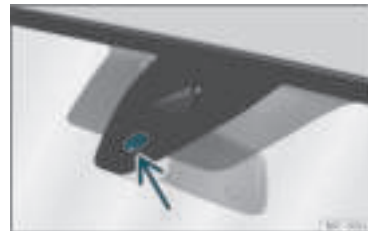
Rys. 101 Powierzchnia aktywna czujnika deszczu »
