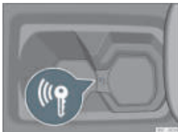
Rys. 154 W konsoli środkowej: rozruch awaryjny.
