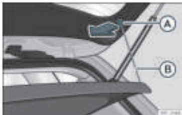
Rys. 114 W bagażniku: zdejmowanie i zakładanie tylnej półki.
