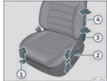
Rys. 104 Siedzenia przednie: regulacja ręczna.
