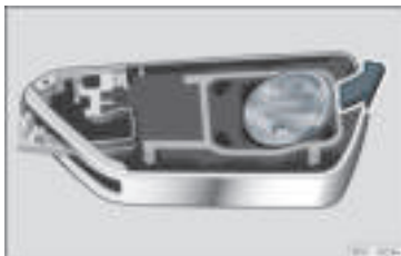
Rys. 77 Kluczyki samochodowe: wymiowanie baterii.
