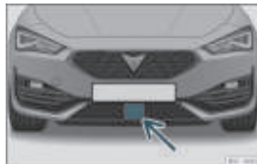
Rys. 159 Na przednim zderzaku: czujniki radarowe.
