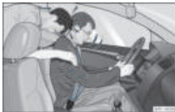
Rys. 12 Pasażer na tylnym siedzeniu nieposiadający zapiętych pasów bezpieczeństwa zostaje gwałtownie wyrzucony do przodu, uderzając kierowcę, który ma zapięty pas.
