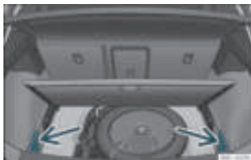
Rys. 116 W bagażniku: osłony do schowania tylnej półki.
