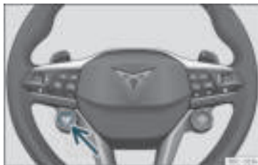
Rys. 158 Kierownica wielofunkcyjna*: przycisk do zmiany profilu jazdy.
