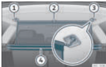
Rys. 131 W bagażniku: mocowanie siatki dzielącej.
