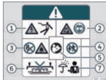
Rys. 201 Napis ostrzegawczy akumulatora wysokonapięciowego.
