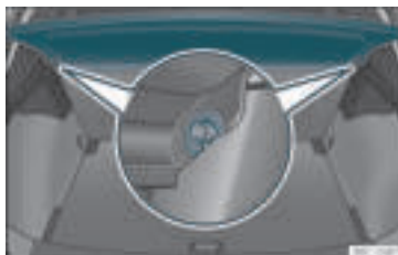
Rys. 115 W bagażniku: zdejmowanie i zakładanie tylnej półki.
