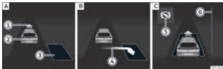
Rys. 191 Na wyświetlaczu tablicy przyrządów: parkowanie równoległe. [A] Znajdowanie miejsca parkingowego. [B] Miejsce do zaparkowania. [C] Manewrowanie.
