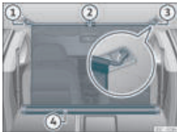
Rys. 134 W bagażniku: zamontowana siatka dzieląca przy złożonych oparciach siedzeń tylnych.
