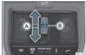
Rys. 92 W podsufrce: przycisk sterowania otwieraniem dachem.
