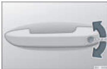
Rys. 82 Klamka drzwi kierowcy: cylinder zamka.
