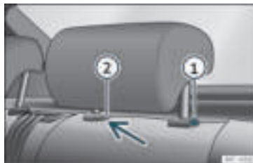
Rys. 108 Zagłówek z tyłu: zdejmowanie.
