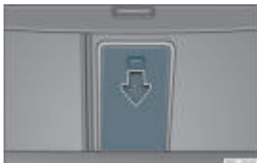
Rys. 130 W bagażniku: otwieranie przejścia do bagażnika.
