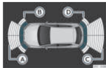
Rys. 194 Widok Asystenta parkowania na ekranie systemu Infotainment.
