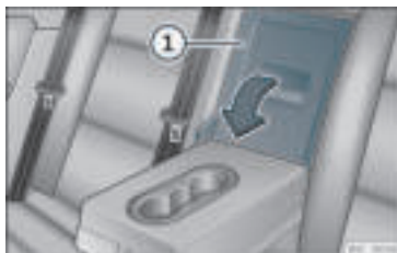
Rys. 129 W oparciu tylnego siedzenia: otwieranie przejścia do bagażnika.
