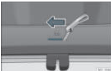
Rys. 89 Szczegół bagażnika: zwolnienie awaryjne (Leon).
