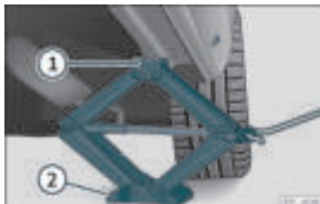
Rys. 43 Belka poprzeczna: podstawianie podnośnika pod pojazdem.
