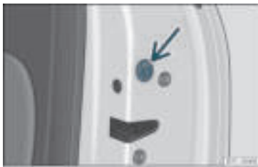
Rys. 83 Ręczne ryglowanie drzwi.
