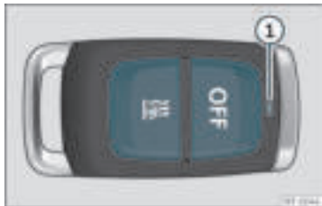
Rys. 144 Ogrzewanie pomocnicze: pilot radiowy zdalnego sterowania.
