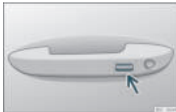
Rys. 93 Klamka drzwi: powierzchnia czujnika.
