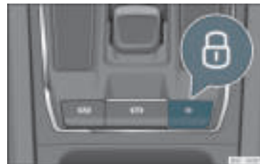
Rys. 79 W konsoli środkowej: przycisk centralnego zamka
