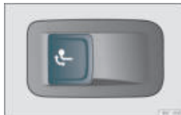
Rys. 198 Po lewej stronie bagażnika: przycisk do odblokowania zaczepy.
