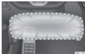
Rys. 22 Po stronie kierowcy: promień działania poduszki chroniącej kolana.
