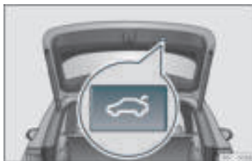
Rys. 86 Kłapa bagażnika: przycisk do zamykania klapy bagażnika.
