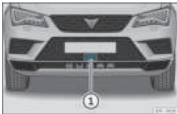
Rys. 186 Na przednim zderzaku: czujniki radarowe.
