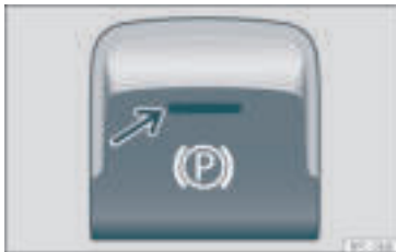
Rys. 200 W dolnej części konsoli środkowej: elektryczny hamulec postojowy
