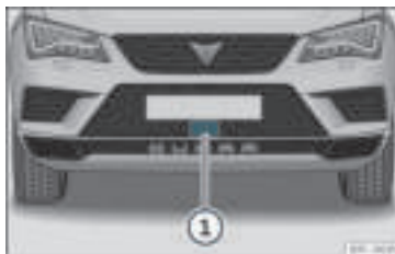
Rys. 181 Na przednim zderzaku: czujniki radarowe.
