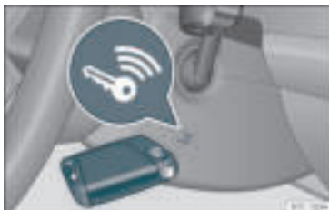
Rys. 168 Po prawej stronie kolumny kierowcy: rozruch awaryjny.
