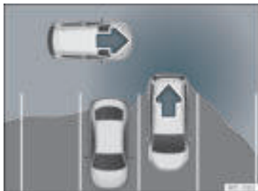
Rys. 199 Diagram przedstawiający działanie systemu asystenta wyjazdu: obszar monitorowany wokół samochodu wyjeżdżającego z miejsca parkowania.
