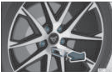
Rys. 30 Koło: śruby kół z nasadkami.
