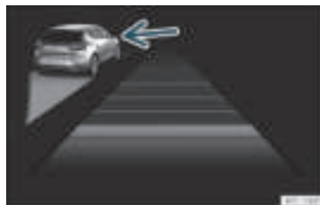
Rys. 189 Na wyświetlaczu tablicy rozdzielczej: ACC aktywny, wykryto pojazd na lewym pasie
