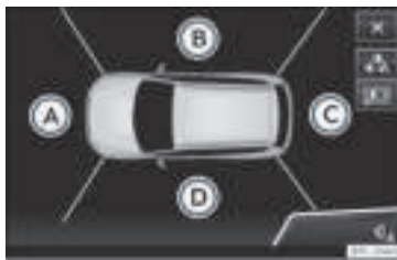
Rys. 214 Podgląd otoczenia: widok z lotu ptaka.
