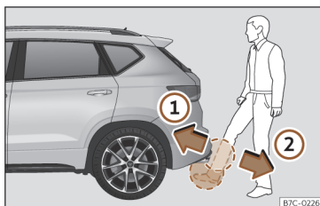
Rys. 57 Kłapa bagażnika z otwieraniem sterowanym za pomocą czujnika (Easy Open).
