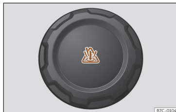
Rys. 194 Komora silnika: korek zbiornika wyrównawczego płynu chłodzącego.
