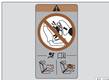
Rys. 34 Naklejka z symbolem poduszki powietrznej: w tylnej części ramy drzwi po stronie pasażera.
