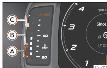
Rys. 4 Wskaźnik temperatury płynu chłodzącego silnika.
