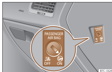
Rys. 25 Przełącznik czołowej poduszki powietrznej pasażera.
