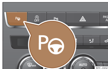
Rys. 131 Górna część konsoli środkowej: przycisk do włączania układu wspomaganie parkowania (Park Assist).
