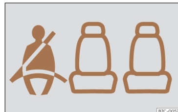
Rys. 16 Zestaw wskaźników: wskazanie stanu pasów bezpieczeństwa tylnych siedzeń.
