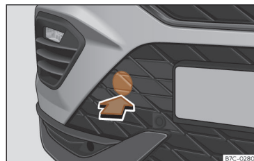
Rys. 183 Zderzak przedni po prawej stronie: zdejmowanie pokryw.
