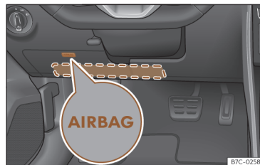
Rys. 30 Po stronie kierowcy: umiejscowienie poduszki powietrznej chroniącej kolana.
