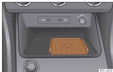
Rys. 156 Konsola środkowa: slot do podłączenia telefonu komórkowego.
