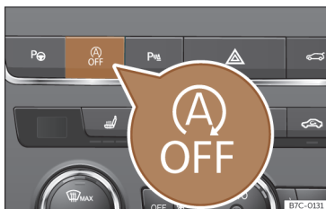
Rys. 91 Konsola środkowa: Przycisk systemu Start-Stop.
