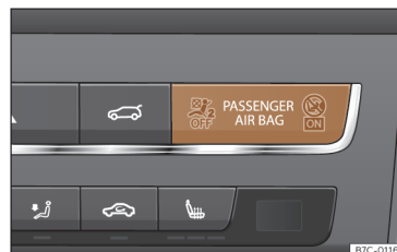
Rys. 26 Deska rozdzielcza: lampka kontrolna dezaktywacji czołowej poduszki powietrznej pasażera na konsoli środkowej.
