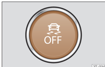
Rys. 98 W dolnej części konsoli środkowej: Przycisk wł./wył. systemu ESC
