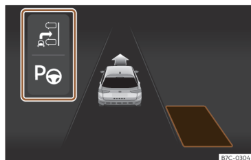
Rys. 132 Na wyświetlaczu tablicy przyrządów: wyświetlanie układu wspomagania parkowania przy ograniczonej widoczności.
