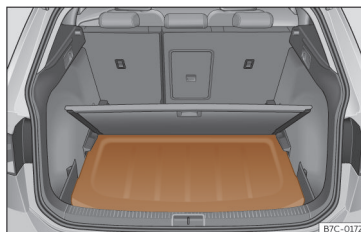
Rys. 160 W bagażniku: wkładanie tylnej półki.
