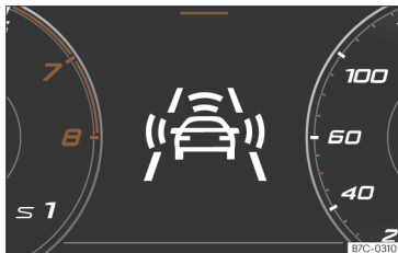
Rys. 114 Na wyświetlaczu tablicy rozdzielczej: wczesne ostrzeżenia.
