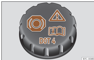
Rys. 195 Komora silnika: korek zbiornika płynu hamulcowego.
