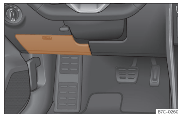
Rys. 187 Na desce rozdzielczej po stronie kierowcy: pokrywa skrzynki bezpieczników.
