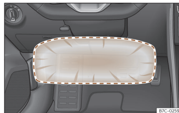
Rys. 31 Po stronie kierowcy: promień działania poduszki powietrznej chroniącej kolana.
