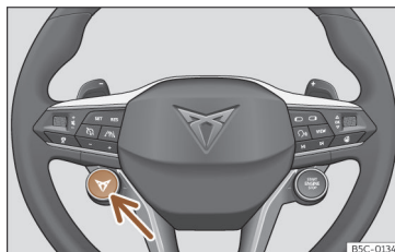
Rys. 97 Kierownica wielofunkcyjna: przycisk zmiany profilu jazdy.
