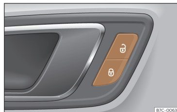
Rys. 49 Na drzwiach kierowcy: przycisk centralnego zamka.
