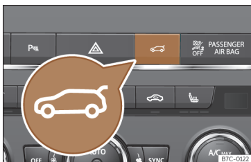
Rys. 56 Konsola środkowa: przycisk do otwierania i zamykania klapy bagażnika.
