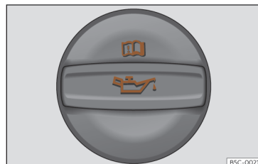
Rys. 200 Osłona korka wlewu oleju w komorze silnika
