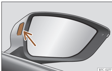
Rys. 121 Lampka kontrolna pojazdu systemu ostrzegania o zjeżdżaniu z pasa ruchu.
