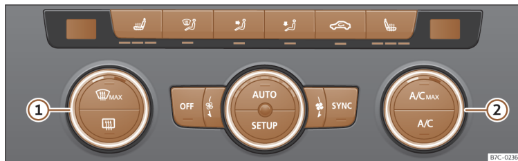
Rys. 86 Na konsoli środkowej: panel sterowania Climatronic.
