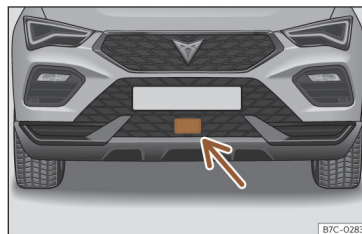
Rys. 101 Na przednim zderzaku: czujnika radarowe.
