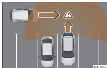
Rys. 143 Schemat asystenta parkowania: wykryty obszar wokół odjeżdżającego pojazdu.
