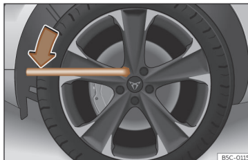
Rys. 167 Wymiana koła: luzowanie śrub koła.
