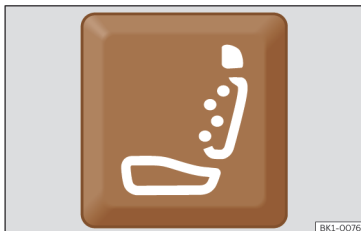
Rys. 80 W dolnej części siedzenia kierowcy: przycisk funkcji masażu.
