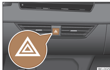
Rys. 40 Tablica rozdzielcza: przełącznik świateł awaryjnych
