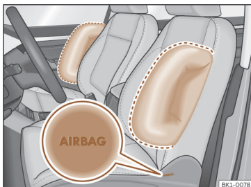
Rys. 29 Boczne poduszki powietrzne pasażera i kierowcy.
