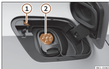
Rys. 48 Za pokrywą ładowania akumulatora, z tyłu po prawej stronie: Gniazdo ładowania
