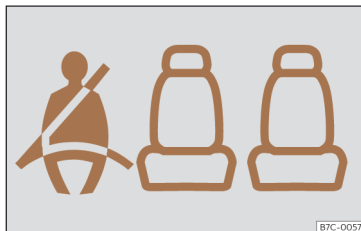
Rys. 15 Tablica przyrządów: kontrolka zapięcia tylnych pasów bezpieczeństwa
