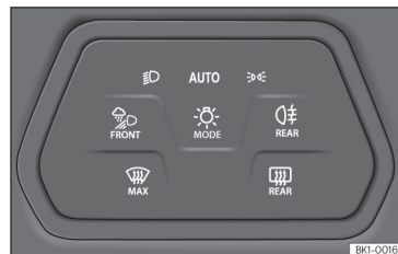
Rys. 81 Tablica rozdzielcza: przyciski sterowania światłami.
