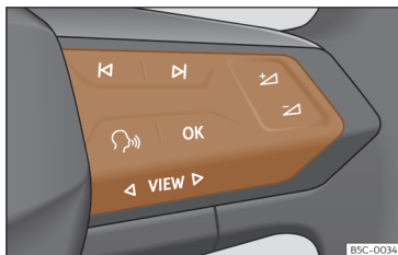
Rys. 71 Przyciski sterujące umieszczone na kole kierownicy.
