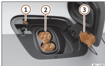
Rys. 49 Za pokrywą ładowania akumulatora, z tyłu po prawej stronie: gniazdo ładowania.
