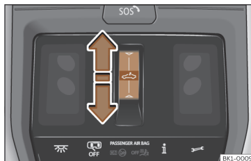
Rys. 90 W podsufitce: przycisk funkcyjny do obsługi rolety przeciwsłonecznej.
