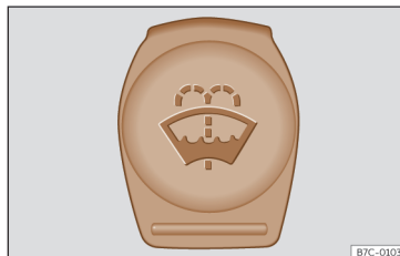
Rys. 160 W komorze silnika: korek zbiornika płynu do spryskiwaczy.
