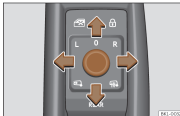
Rys. 88 Widok szczegółowy drzwiczki sterującej: sterowanie lustrem bocznym.
