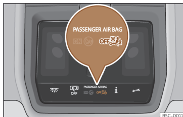
Rys. 26 Na konsoli w podsufitce: lampka kontrolna dezaktywacji przedniej poduszki powietrznej pasażera.
