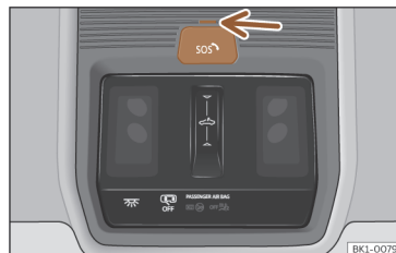
Rys. 41 Na konsoli w podsufitce: przyciski obsługi głosowej
