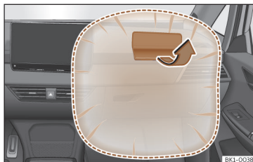
Rys. 24 Czołowa poduszka powietrzna pasażera umieszczona w desce rozdzielczej.
