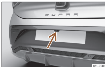
Rys. 100 Na tylnym zderzaku: umiejscowienie kamery cofania.
