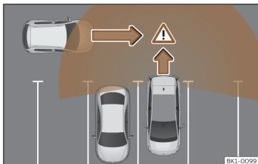
Rys. 115 Schemat systemu monitorowania ruchu poprzecznego przy cofaniu: obszar monitorowany wokół pojazdu wyjeżdżającego z miejsca parkowania.
