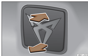
Rys. 67 Klapa bagażnika: otwierana od zewnątrz.
