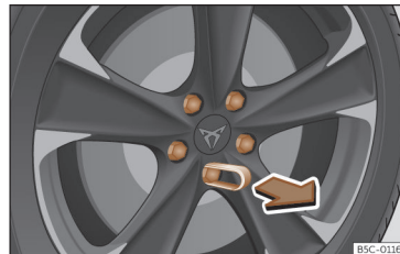
Rys. 165 Koło: śruby kół z nasadkami.
