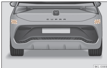
Rys. 98 Widok tylnej części pojazdu: strefy czujników radarowych.
