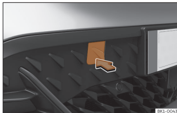
Rys. 149 Z prawej strony zderzaka przedniego: zdejmowanie osłony.
