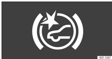
Rys. 107 Na wyświetlaczu tablicy rozdzielczej: wczesne ostrzeżenia.
