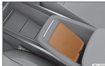
Rys. 133 W konsoli środkowej: miejsce do podłączenia telefonu komórkowego.
