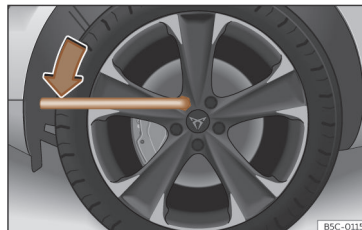
Rys. 233 Wymiana opon: luzowanie śrub koła.
