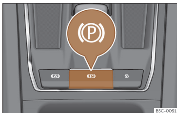
Rys. 145 Dolna część konsoli środkowej: przycisk elektronicznego hamulca postojowego.
