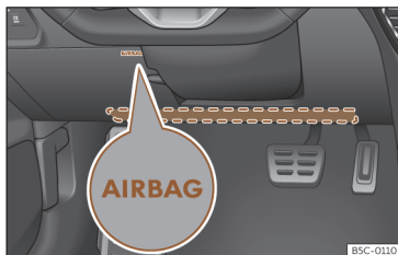
Rys. 36 Po stronie kierowcy: umiejscowienie poduszki powietrznej chroniącej kolana.
