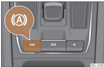
Rys. 146 W dolnej części konsoli środkowej przycisk funkcji Auto Hold.
