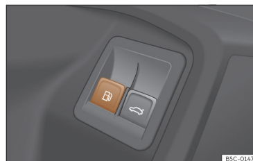
Rys. 200 Drzwi kierowcy: zwalnianie klapki wlewu.
