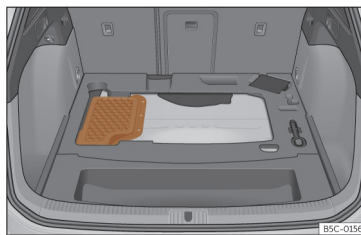
Rys. 224 Pojazdy hybrydowe (PHEV): umieszczenie akumulatora w bagażniku
