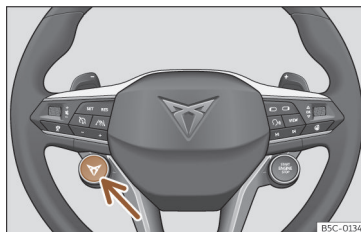
Rys. 117 Kierownica wielofunkcyjna: przycisk zmiany profilu jazdy.
