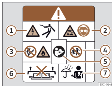
Rys. 53 Napis ostrzegawczy akumulatora wysokonapięciowego.
