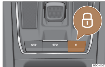
Rys. 71 Na konsoli środkowej: przełącznik zamka centralnego
