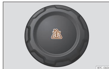
Rys. 217 Komora silnika: korek zbiornika wyrównawczego płynu chłodzącego.
