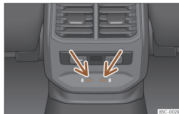
Rys. 164 Tylna konsola środkowa: gniazda USB z funkcją gniazda zasilania.
