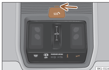
Rys. 50 Na konsoli w podsufitce: sterowanie usługami głosowymi.
