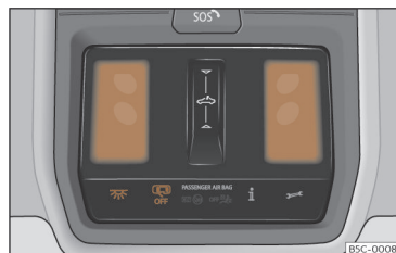
Rys. 101 Szczegółowy widok podsufitki: oświetlenie przedniej części wnętrza.
