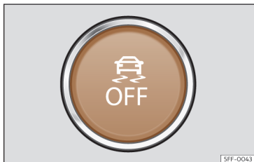
Rys. 118 W dolnej części konsoli środkowej: Przycisk wł./wył. systemu ESC
