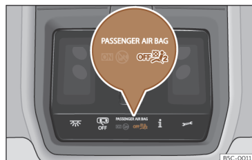
Rys. 30 Na konsoli w podsufitce: lampka kontrolna dezaktywacji poduszki powietrznej pasażera.
