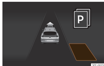
Rys. 149 Na wyświetlaczu tablicy przyrządów: wyświetlanie układu wspomagania parkowania przy ograniczonej widoczności.
