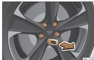
Rys. 232 Koło: śruby kół z nasadkami.
