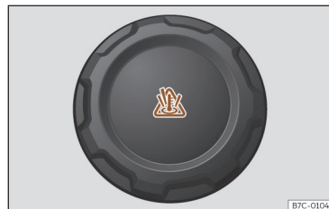
Rys. 217 Komora silnika: korek zbiornika wyrównawczego płynu chłodzącego.
