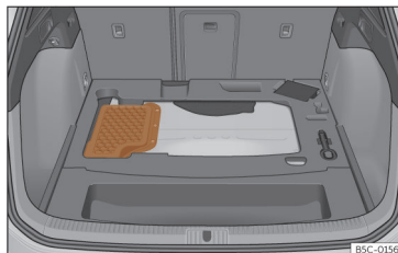
Rys. 224 Pojazdy hybrydowe (PHEV): umiejscowienie akumulatora w bagażniku
