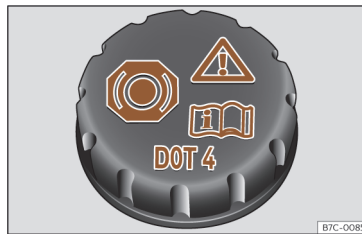
Rys. 218 Komora silnika: korek zbiornika płynu hamulcowego.
